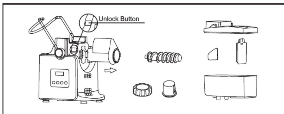
Перед разборкой убедитесь, что устройство отключено от электросети. Забирайте детали поочередно. Для того, чтобы снять загрузочную камеру, нажмите на кнопку открывания и поворачивайте камеру. Прочистите основную часть устройства с помощью влажной тряпки, остальные детали можно промывать под водой. Остатки муки удалите с помощью кисточки. После чистки, дождитесь полного высыхания устройства, поместите прибор в хорошо проветриваемое помещение.
