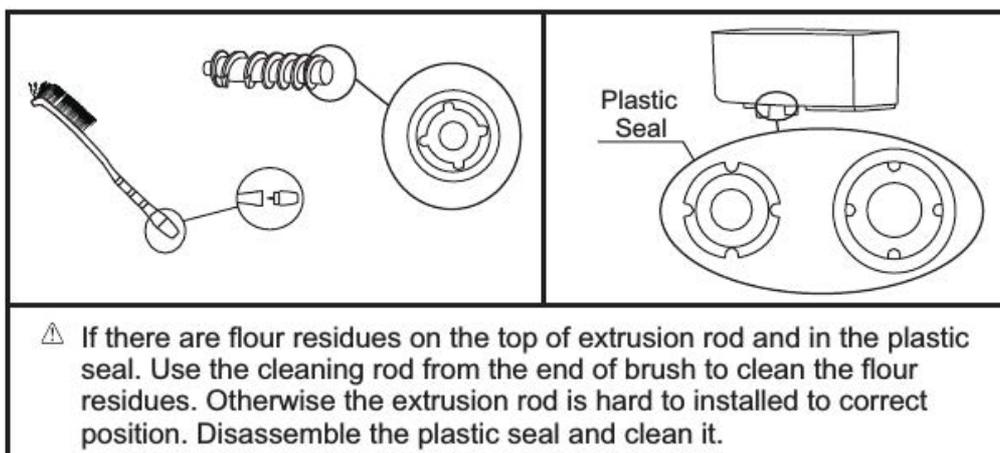
⚠ При обнаружении остатков муки в загрузочной камере и на пластиковых поверхностях, используйте специальную кисточку для чистки. Снимите пластиковые части и прочистите их.
