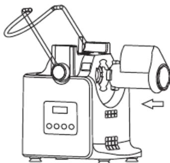
Поместите устройство на ровную твердую поверхность. Установите загрузочный поддон и зафиксируйте его, повернув на 45 градусов влево до срабатывания защелки.
