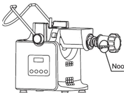
Вкрутите шнек под загрузочный поддон, на него установите насадку и зафиксируйте ее, должна сработать защелка.
