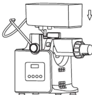
камера замеса теста имеет 3 выступа, вставьте их в отверстия на корпусе устройства.
